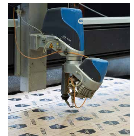
De vanuit BIM4Production® aangestuurde watercutter.
